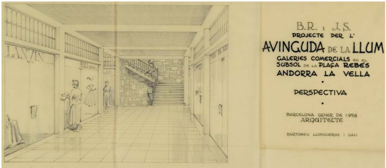
A dalt secció de la futura plaça Rebés amb dos soterranis. El primer amb un restaurant panoràmic badant sobre la vall i, el segon, amb la sortida del telefèric. Al mig poden veure l'escala que uneix ambdós nivells i a l'extrem oposat una lluernia correguda per fer arribar llum natural al subsòl. A sota una de les perspectives dels passatges de botigues. Arxiu històric COAC.
